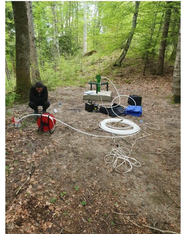
Matériel prélèvement des eaux souterraines (pompe péristaltique 60m)
