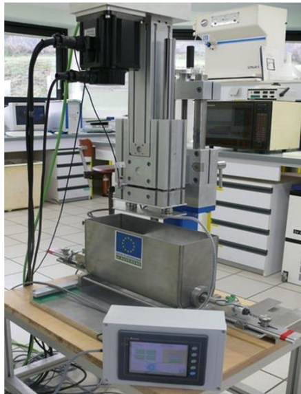
Baratte de laboratoire : marinage, saumurage et barattage seuls, combinaison des procédés précédents
