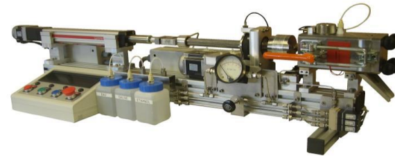
Masticateur artificiel (faculté dentaire, UNH)
